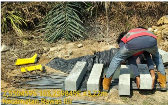
Gambar 3. Benda Uji Balok
