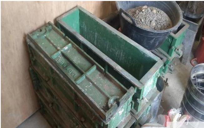
Gambar 2. Cetakan Benda Uji
