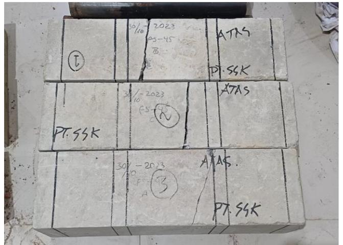
Gambar 7. Pola retak pada balok
