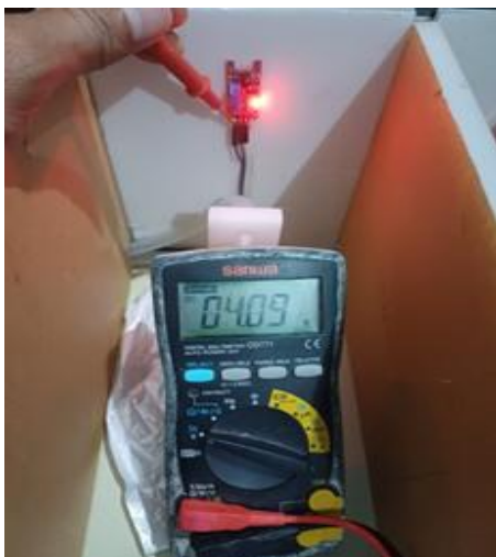
Gambar 11. Pengukuran Tegangan Sensor Api tanpa Api
