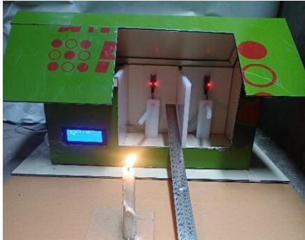
Gambar 13. Pengujian Zona 1 menggunakan api Lilin
