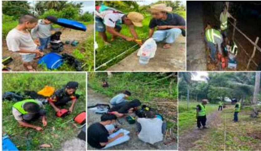
Gambar 9. Kegiatan pengukuran geolistrik pada setiap lintasan
