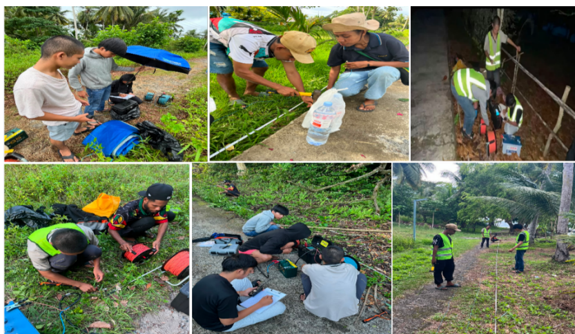
Gambar 9. Kegiatan pengukuran geolistrik pada setiap lintasan
